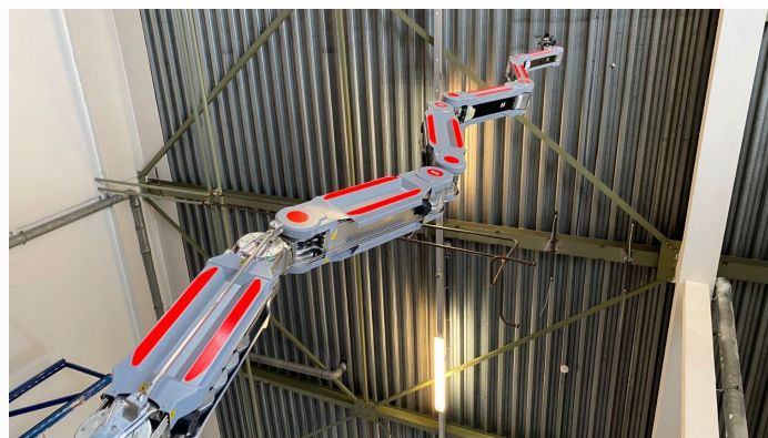
ハイボット社のインフラ点検用ヘビ型ロボット
