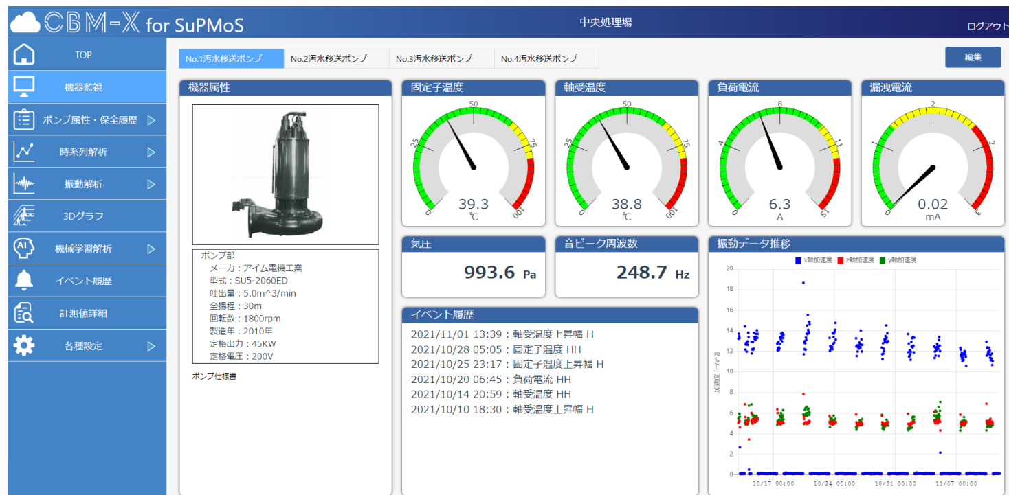
▲ 水中ポンプの状態が画面で確認でき、状態監視やデータ分析も可能
