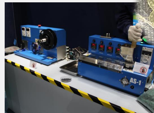
小型押出機・3Dプリンターを使って、 廃漁網を原料にREAMIDE製ウミガメをデザイン
