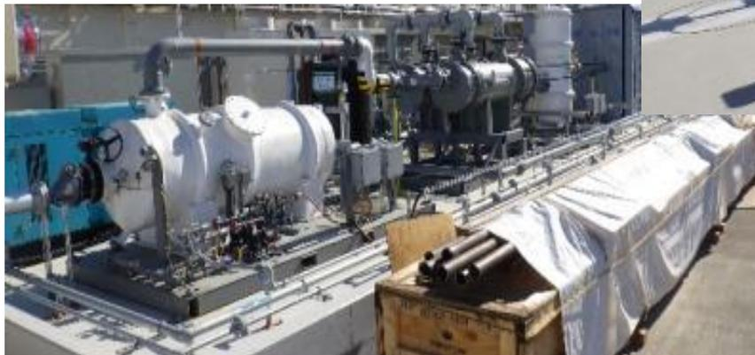
回収した汚染物質の無害化処理装置
